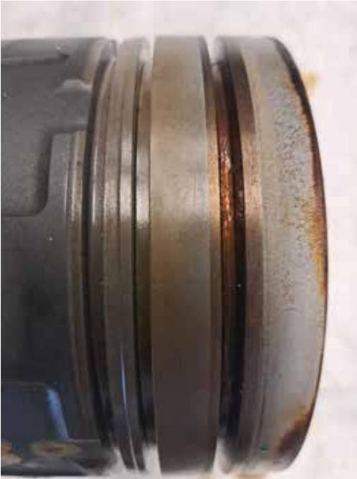
**Pulizia della scanalatura della prima fascia elastica del pistone a fine test**
